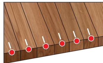
Bei Verbindung von Platten, je nach der Breite, sollen zwei oder drei Klammern an jeder Verbindung eingesetzt werden.
